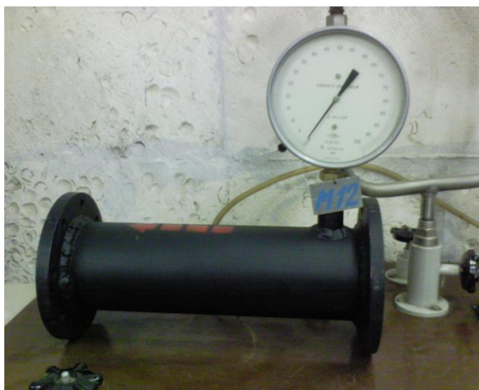
Рис.1 Общий вид опытного устройства динамической обработки. Манометр показывает давление на входе в устройство.
